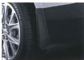
23266909 マッドガード(フロント用) 希望小売価格 15,120円(税込) アンチステップ装着車用 別途アンチステップ(品番:84059167)が必要となります
